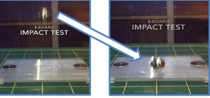
事例：尖った飛散物はリブ構造が吸収
