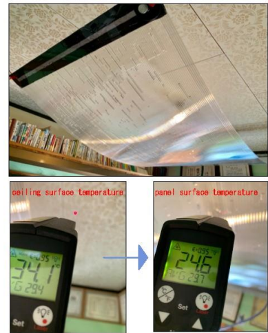
写真：通水によりパネル表面が薄らと結露した。
