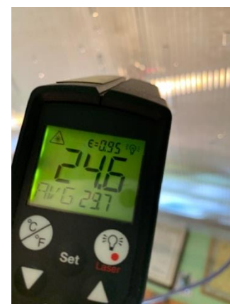
通水後のパネル面温度 約25℃
