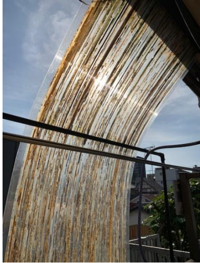
上記パネルは内部に微生物膜を作り水質浄化に使用された再生品
