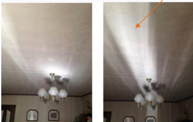
写真左: 窓ガラスのみ 写真右: 中空ハモニカ構造による反射光
