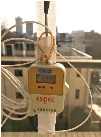
窓ガラス内面測定ロガー
