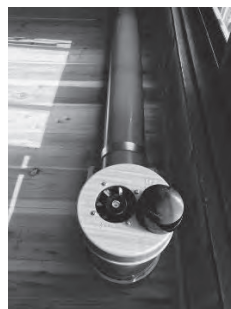
図 22 全体、熱交換器、冷却用ファン
