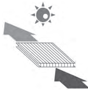
図2 中空ハモニカ構造における採熱原理
