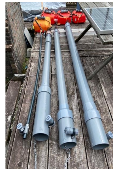
実験用ポンプ写真
