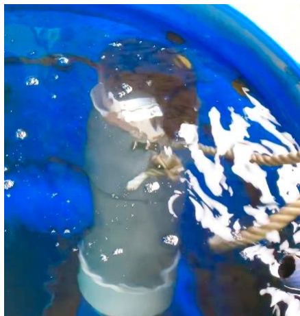
200リットル水槽試験：低層堆積物汲み上げ確認
