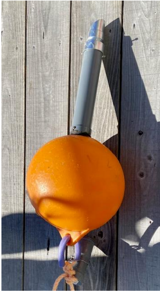
計測用ブイ：上部に対気温記録用ロガー
