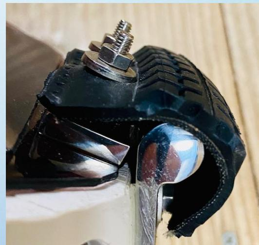
弁部接続管=内径100mm/下部接続管=内径150mm/弁体=ポリカーボネート2重構造/留め具=SUS316/ヒンジ=6mm軸
